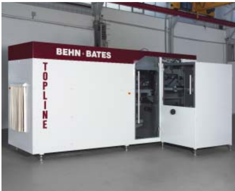
Rückansicht des TOPLINE mit Leersackmagazin und Sackanleger
