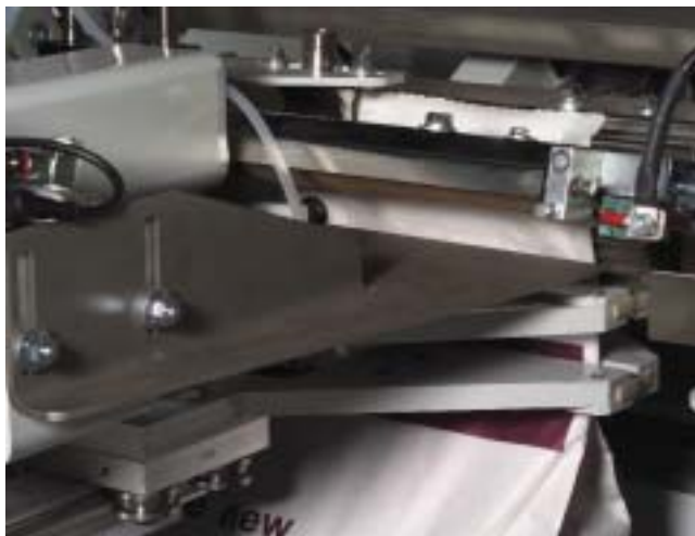
Verschweißung des PE-Inliners
