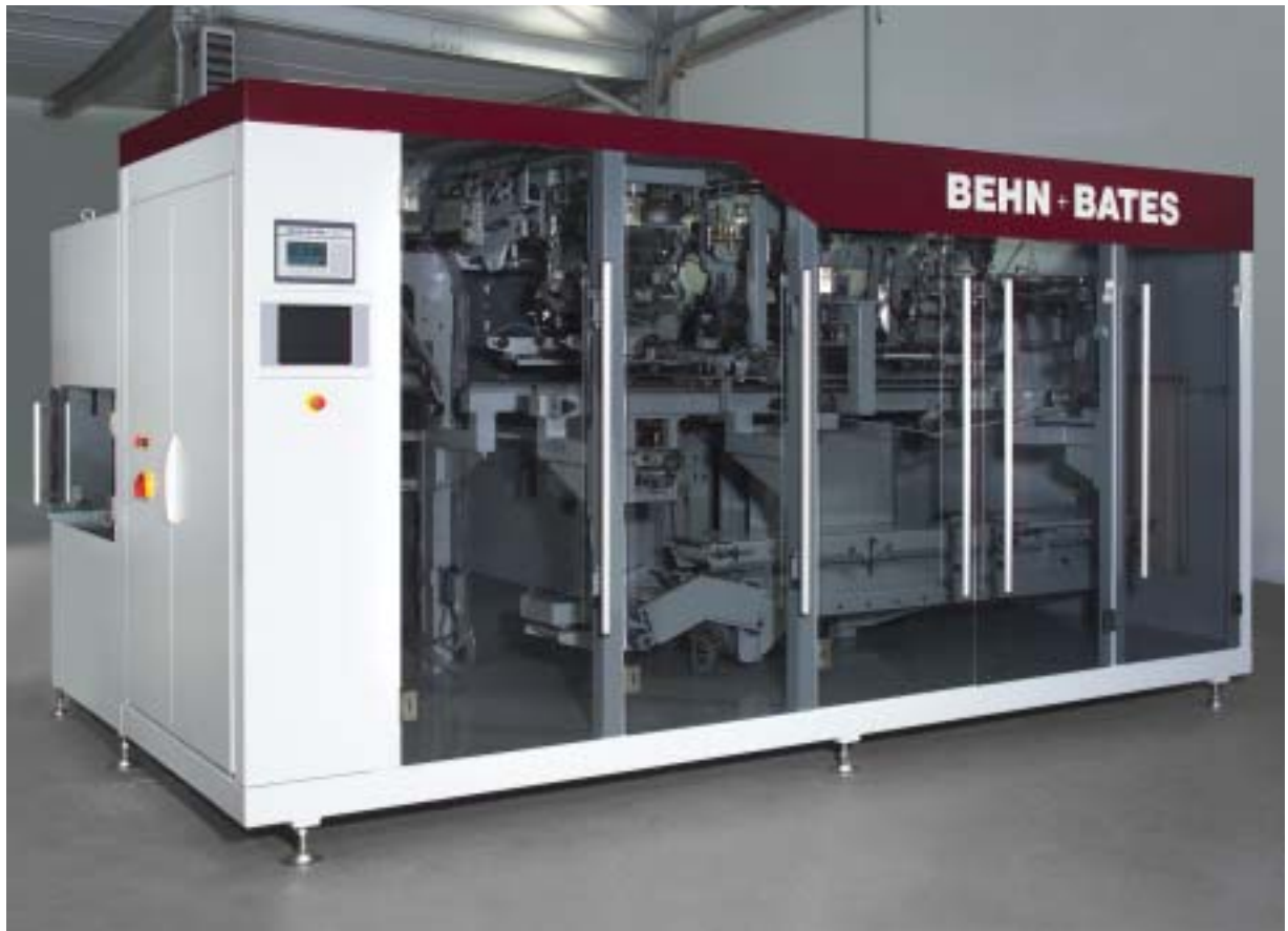
TOPLINE-Verpackungssystem mit seitlichem Sackmagazin
