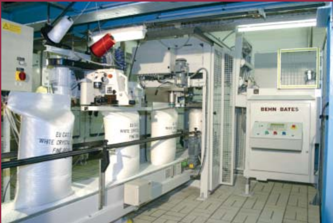
BEHN + BATES-Sackomat - Der Hochleistungsautomat für offene Säcke (bis zu 1.200 Sack/Stunde)
