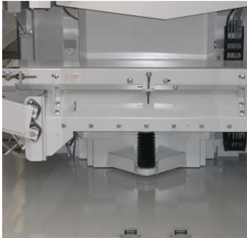
Abgehängtes, höhenverstellbares Sackaustrageband und glatter Maschinenboden zur leichten Reinigung
