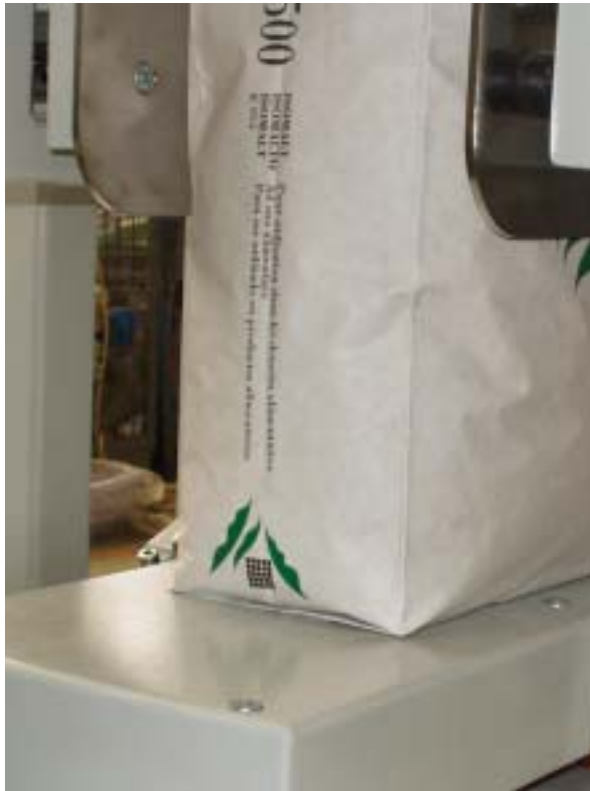
Perfekte Sackform durch Einsatz von Rüttlern
