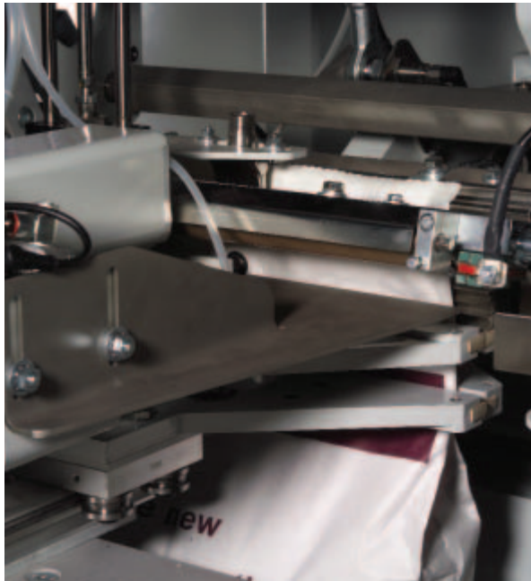
Sealing of the PE inliner
