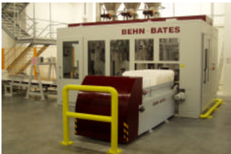
INTEGRA-Verpackungssystem für Ventilsäcke mit integrierter Aufsteck-, Füll- und Verschleißeinheit
