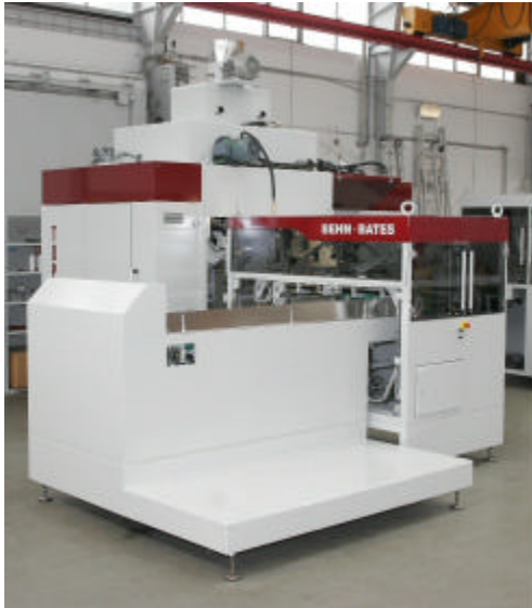
Gesamtansicht des kompakten TOPLINE-Systems von „hinten“ mit Leersackmagazin, das projektgerecht mit einem kleinen Podest zum einfachen Nachlegen der leeren Säcke ausgestattet wurde
