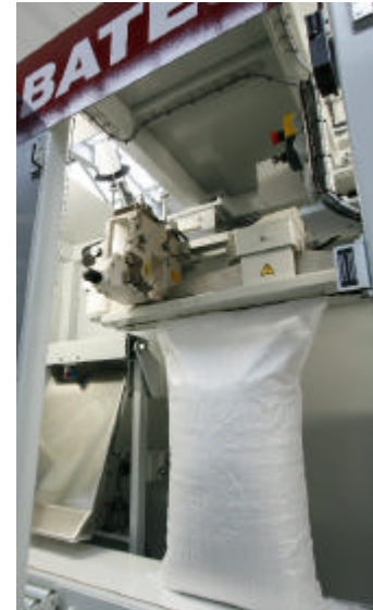
Gefüllter Sack in der Verschließstation, in diesem Fall: Nähstation
