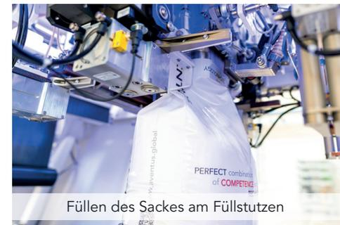
Füllen des Sackes am Füllstutzen
