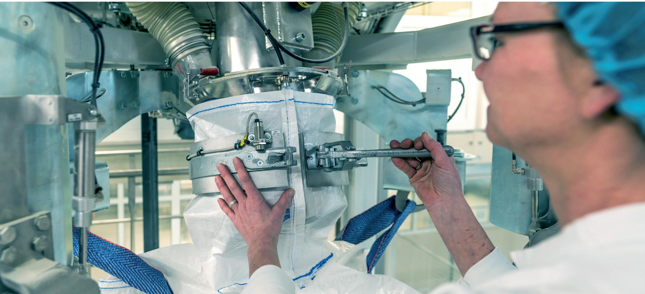
Üblicherweise werden die Produkte aus der Zuckerindustrie nicht nur in Ventil- oder FFS-Säcke, sondern auch in Big Bags abgefüllt. BEHN + BATES liefert Großsackwaagen für hohe Leistungen in hygienischer Ausführung, mit und ohne automatischen Palettentransport.
