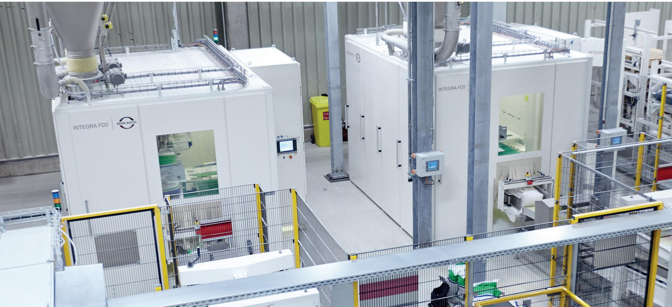
Gedämpfte Maschinengeräusche, saubere Arbeitsumgebung: dank unseres Plug 'n Pack- Konzepts erfolgt der gesamte Aufsteck-, Füll- und Verschleißprozess in einer staubdicht gekapselten Kabine.
