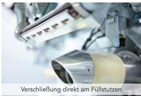
Verschließung direkt am Füllstutzen
