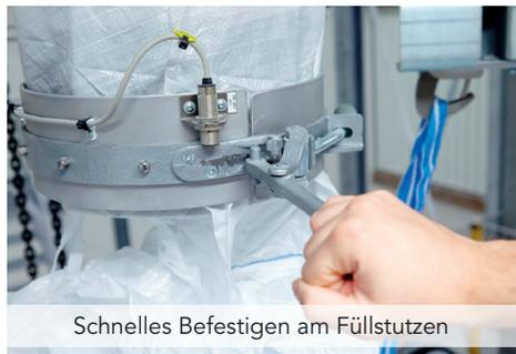
Schnelles Befestigen am Füllstutzen
